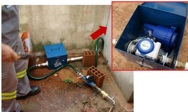
Figura 3.6 – Técnica de campo para estimativa da submedição
