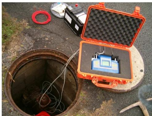
Figura 3.5 – Medidores de vazão ultrassônico - fixo e portátil
