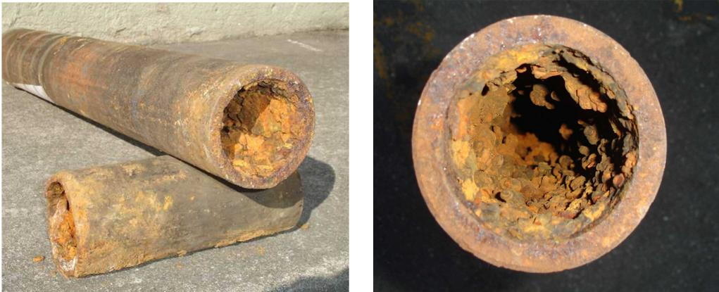
Figura 5.5 – Tubulações (DN 75) retiradas de redes hidráulicas de São Paulo
