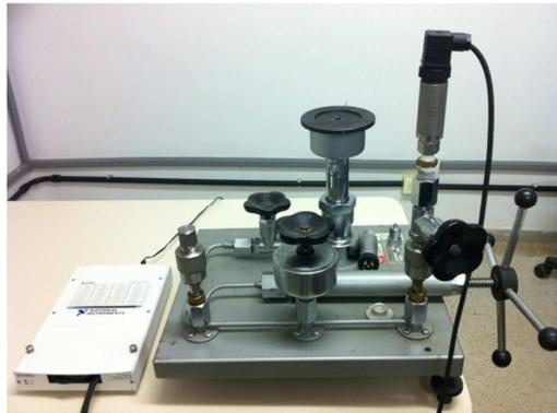
Figura 4.1 – Balança de peso morto para calibração de transdutores de pressão
