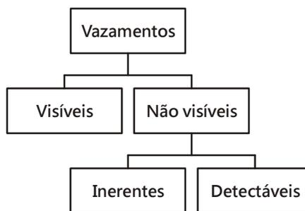
Figura 3.11 – Classificação dos vazamentos
