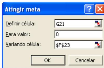
Figura 9.9 – Determinação da TIR através da caixa de diálogo “atingir meta”
