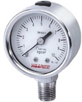
Figura 6.17 – Aspecto típico de um manômetro do tipo Bourdon
