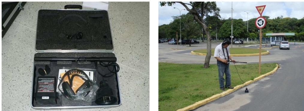
Figura 5.3 – Geofone eletrônico
