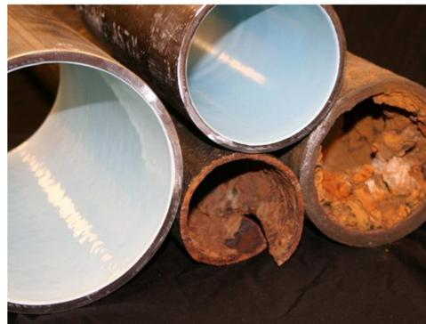
Figura 5.6 – Tubos não reabilitados e após a aplicação do revestimento epoxy
