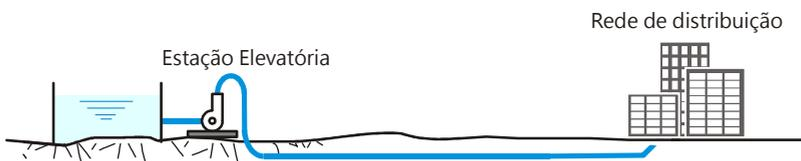
Figura 6.14 – Bombeamento direto na rede de distribuição de água
