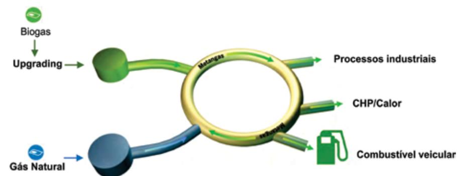
**Figura 33** – Usos do biometano a partir de sua injeção na rede de gás natural.
