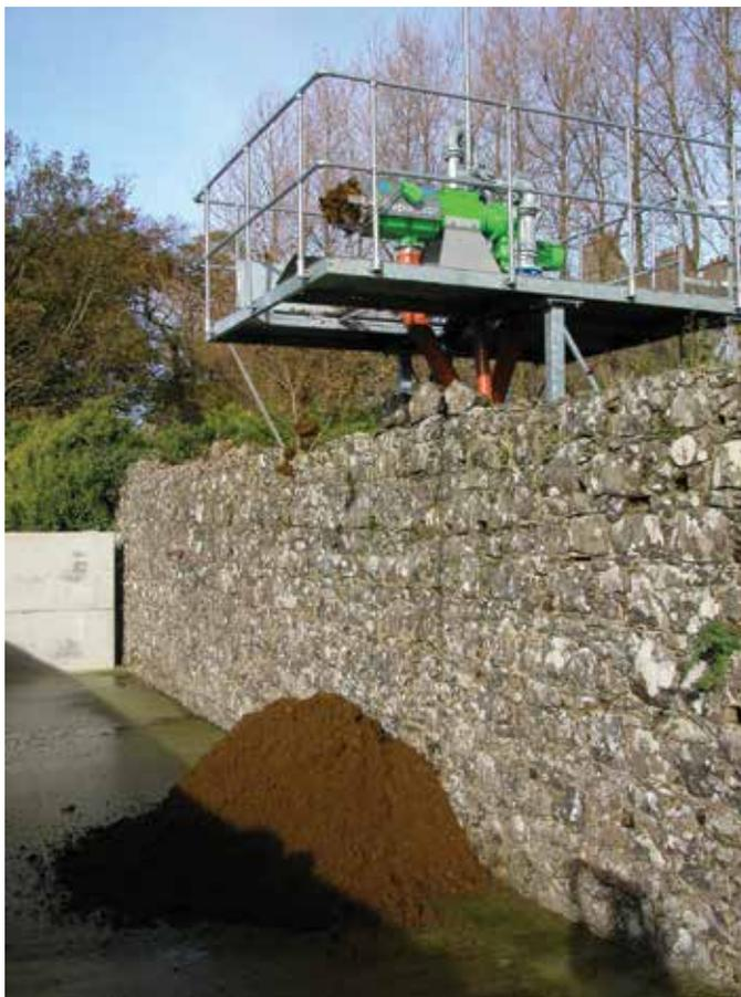
**Figura 40** – Extrusora para separação sólido-líquido do material digerido de uma planta de biogás.
