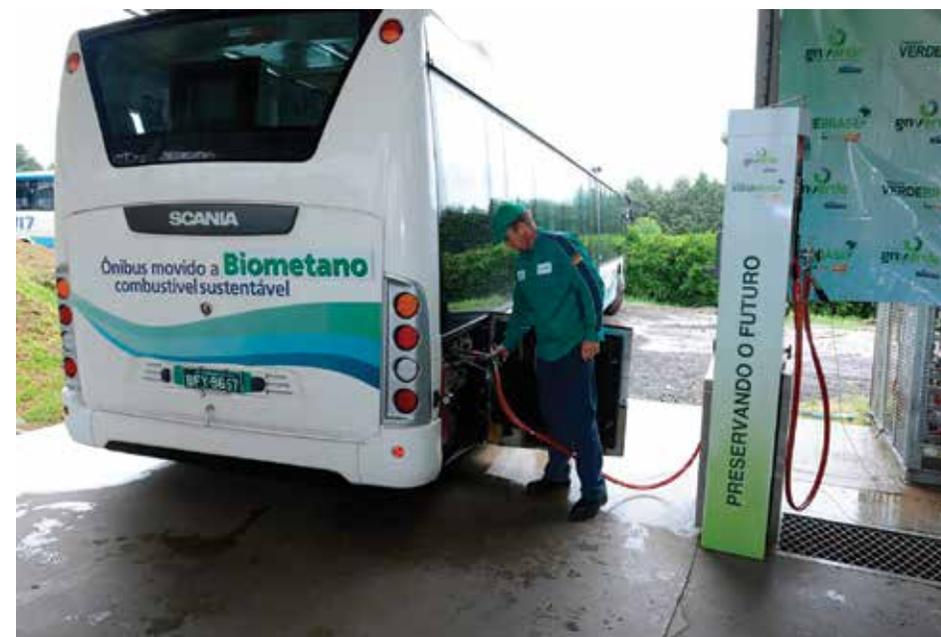
**Figura 35** – Ônibus sendo abastecido com biometano em Triunfo, RS. Fonte: Scania, 2015.
