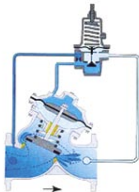
Figura 16 – Exemplo de válvula redutora de ação indireta (com válvula piloto)
