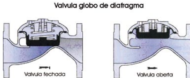
Figura 18 – Válvula redutora de diafragma
