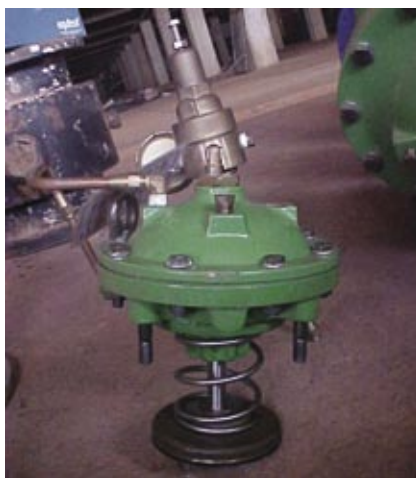
Figura 21 – foto de atuador de câmara dupla fora do corpo da válvula
