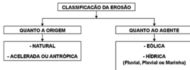
Figura 5.14: Classificação da Erosão
