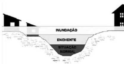
Figura 7.1: Esquema de enchente e inundação (Mcidades, 2007)
