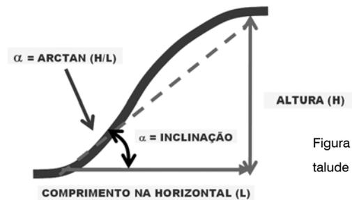
Figura 5.2: Elementos geométricos básicos de um talude (IPT, 2004)
